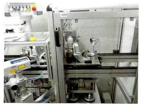
▲ Abb. 5: Einbau des Prüfsystems in eine eigene Prüfkammer mit Ausbevorzugung. Mit der übergeordneten SPS wird über ProfiNET kommuniziert. Bild: RTE
